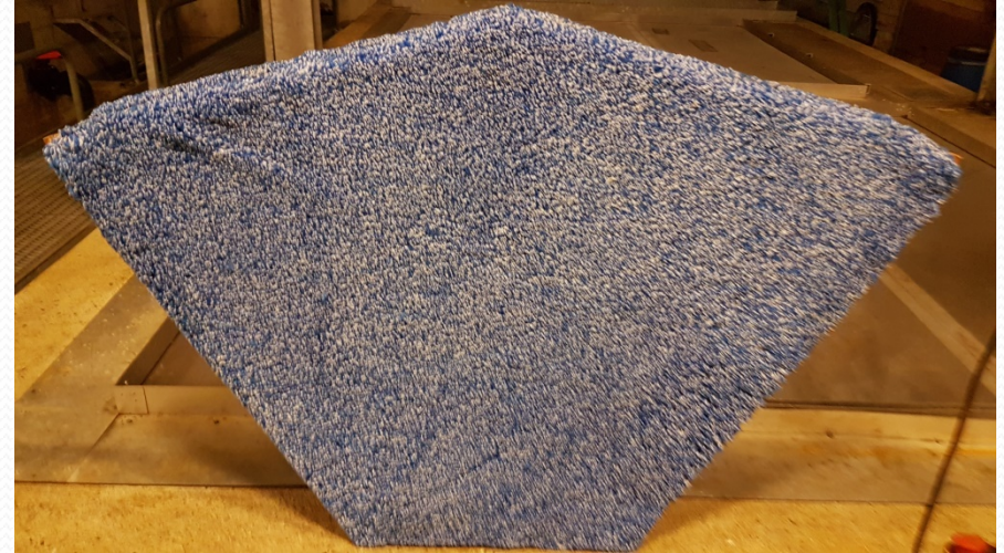
Un élément de filtre recouvert de sa toile. Un filtre complet est composé de 36 toiles
